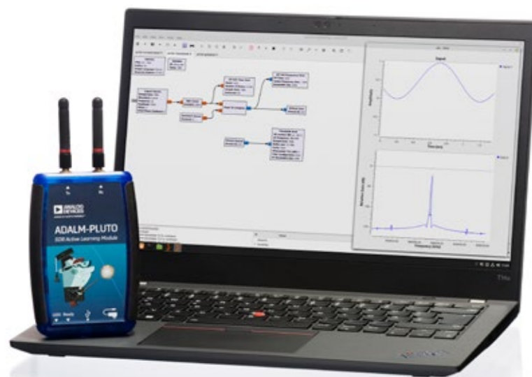
2 Abbildung: Die verwendete Hardware: Ein Adalm-Pluto und ein gewöhnliches Notebook. Bild: Florian Ernst/Hochschule Augsburg.
